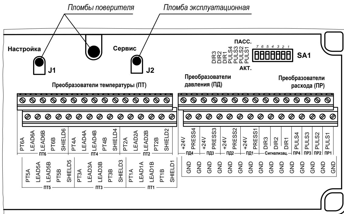
**Рис.А.4. Места пломбирования ТВ в отсеке коммутации.**
